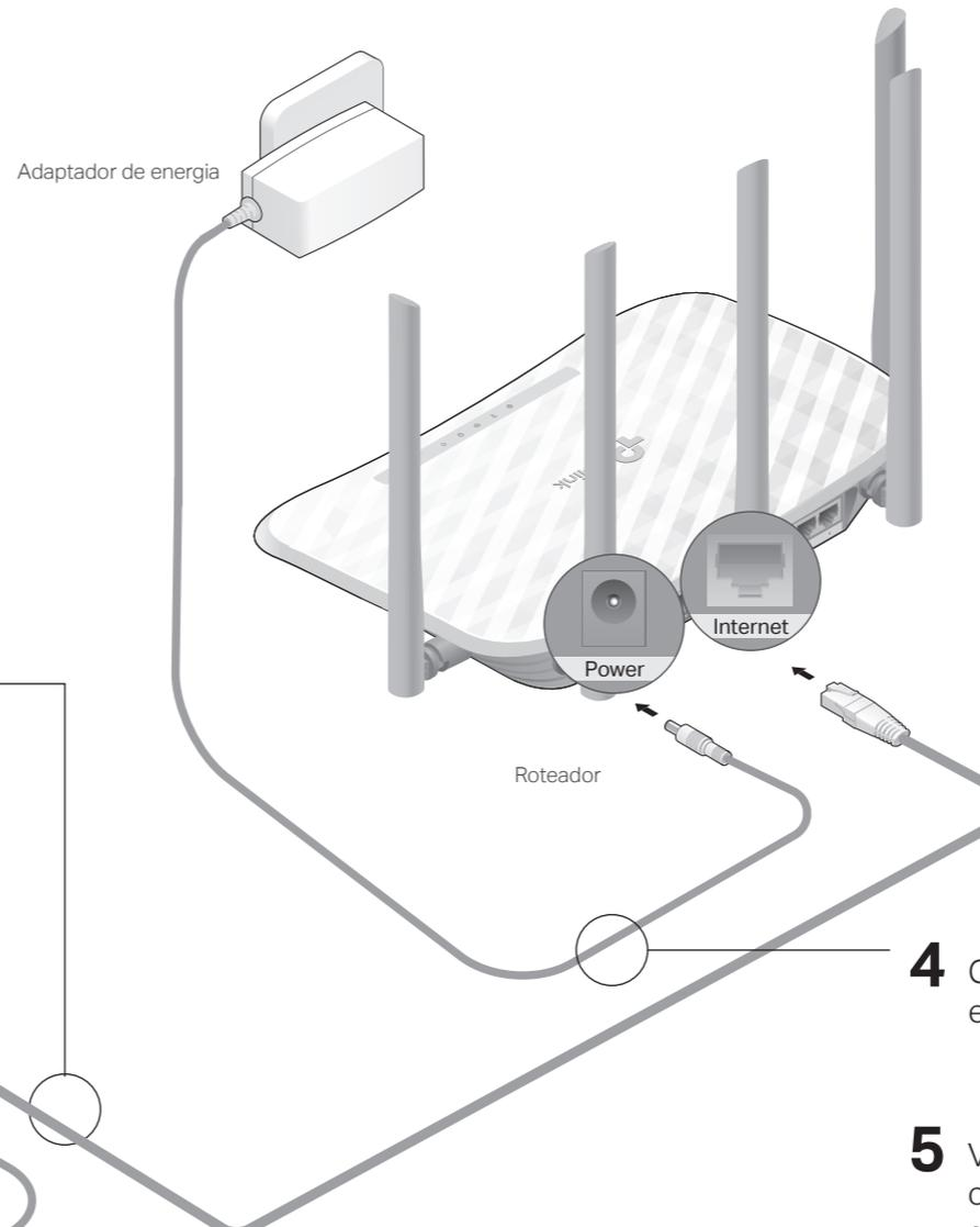
**4** Conecte o adaptador de energia ao roteador e ligue-o.
