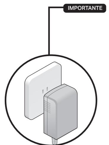
**1** Desconecte o modem e remova a bateria de reserva, se houver.
